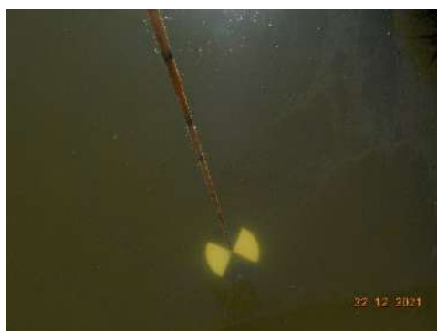
Foto 21 – Disco de Secchi utilizado para medir a transparência (22/12/2021).
